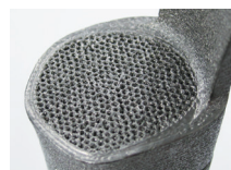
残存した近位上腕骨との接触面に設けた多孔質構造
